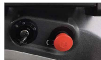
緊急ブレーキスイッチ
