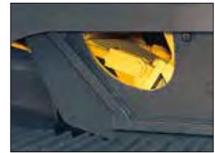
エンジンフレーム側開口部
