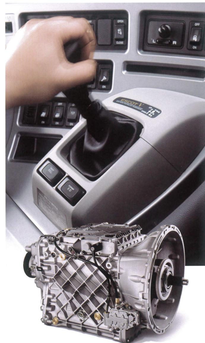
ドライバーの疲労を軽減する、運転が容易な2ペダル操作であり、その上、低速域における微妙なコントロールのしやすさを実現。スイッチONで、発進から停止まで、変速操作も不要になるE・Dモードでは、重量・勾配をより高精度で推定し最適ギヤを選択します。また「ECONOMY E・D」の追加で、さらにエンジン回転を抑えた走行が可能。惰性走行中にスプリッタギヤの切り替えによりエンジンブレーキを遮断して車速の低下を抑制し、再加速時の燃料消費を低減する「ESCOT ROLL」も装備して省燃費運転をサポートします。また、エンジン補助ブレーキのさらなる活用のために「オートシフトダウン機能」の充実を図るなど、ESCOT-Vは、さらに進化しました。
