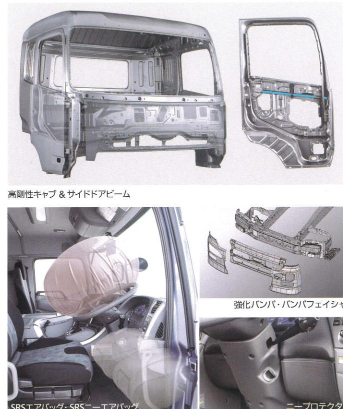
万が一の際に被害を最小限に抑えること。それは私たち輸送に携わる者すべてに課せられた使命もあります。キャブ全体の剛性アップを図るとともに、強度バランスの最適化や乗員周りの車体強度アップにより、衝突安全性の向上を図った高剛性キャブ SAFES CABIN®。そこに、SRSエアバッグや、プリテンショナー付シートベルト、サイドドアビームを装備するとともに、ステアリングホイールやステアリングコラムには衝撃吸収タイプを採用。さらに大型車ではQuonが国内で初めて採用した標準装備のニープロテクタや、トラックでは世界で初めて設定したSRSニーエアバッグ。また、キャブの前方下部にはFUPD(フロントアンダーランプロテクションデバイス)を標準装備し、事故発生時に、前方の乗用車がトラックの下部に潜り込むことを防止し、加害安全性を大幅に向上。Quonは徹底した安全性の追求をおこないました。
